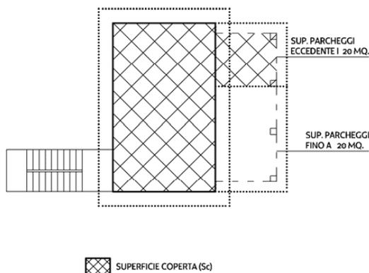
Esempio di misura della superficie coperta (Sc) con tettoia a copertura della superficie per parcheggio (Sp) superiore ai limiti dell'art. 16, comma 1, lett. j) della L.R. 19/2009 [articolo 2 comma 1 lettera a) punti 1 e 4)]
