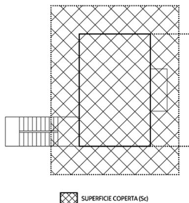
Esempio di misura della superficie coperta (Sc) con sporto di gronda la cui proiezione ortogonale supera la larghezza del limite di legge [articolo 2 comma 1 lettera a) punti 1 e 2)]
