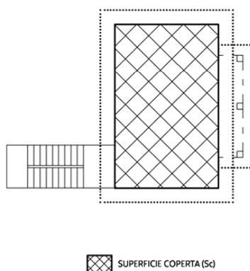
Esempio di misura della superficie coperta (Sc) con porticato la cui proiezione ortogonale non supera la larghezza del limite di legge [articolo 2 comma 1 lettera a) punti 1 e 2)]
