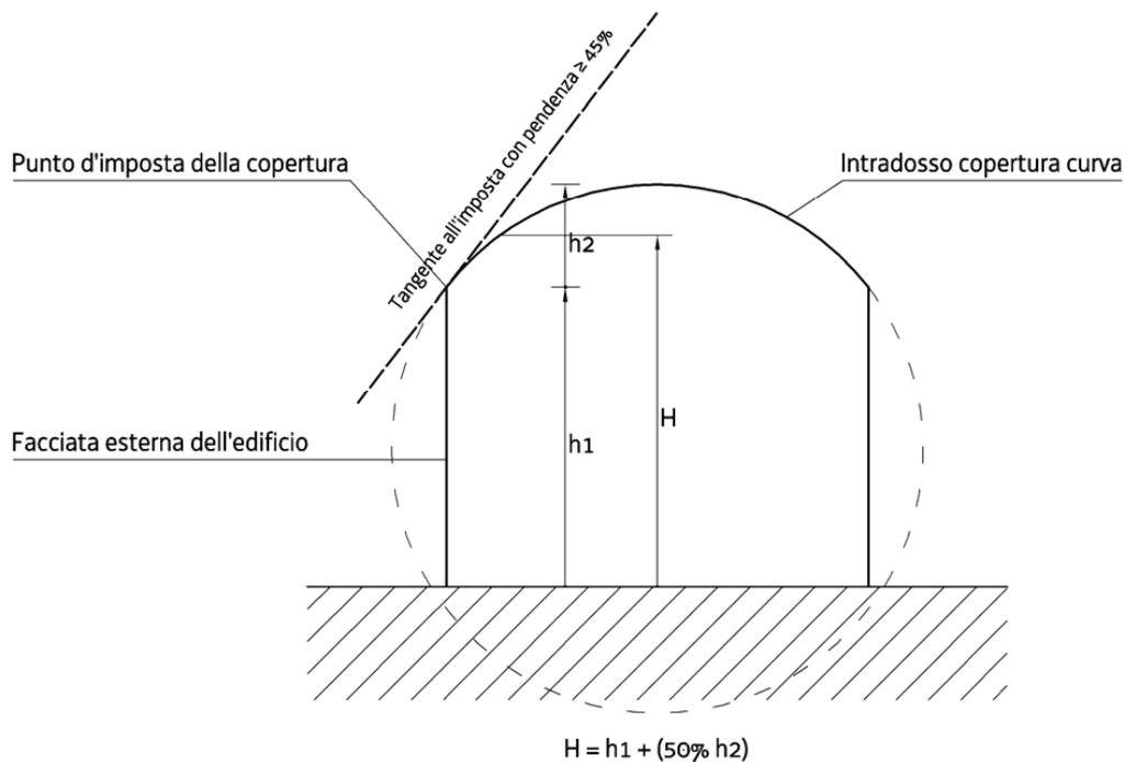
Esempio di misura dell'altezza dell'edificio (H) con copertura curva
