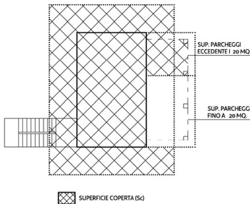
Esempio di misura della superficie coperta (Sc) con tettoia a copertura della superficie per parcheggio (Sp) superiore ai limiti dell'art. 16, comma 1, lett. j) della L.R. 19/2009 [articolo 2 comma 1 lettera a) punti 1 e 4)]
