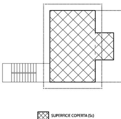
Esempio di misura della superficie coperta (Sc) con poggiolo la cui proiezione ortogonale supera la larghezza del limite di legge [articolo 2 comma 1 lettera a) punti 1 e 2]]
