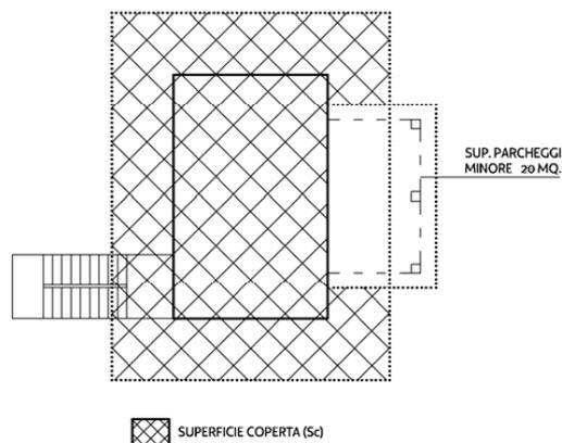
Esempio di misura della superficie coperta ( $S_c$ ) con tettoia a copertura della superficie per parcheggio ( $S_p$ ) nei limiti dell'art. 16, comma 1, lett. j) della L.R. 19/2009 [articolo 2 comma 1 lettera a) punti 1 e 4]
