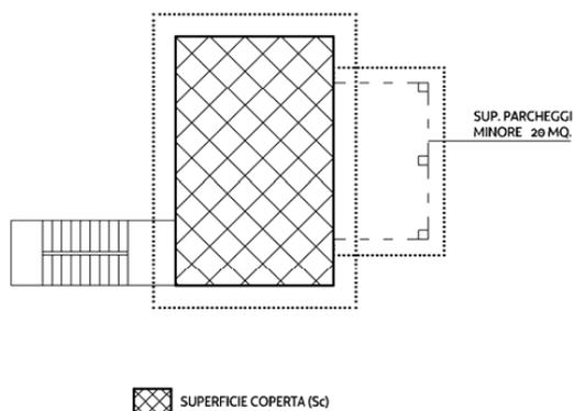
Esempio di misura della superficie coperta (Sc) con tettoia a copertura della superficie per parcheggio (Sp) nei limiti dell'art. 16, comma 1, lett. j) della L.R. 19/2009 [articolo 2 comma 1 lettera a) punti 1 e 4)]
