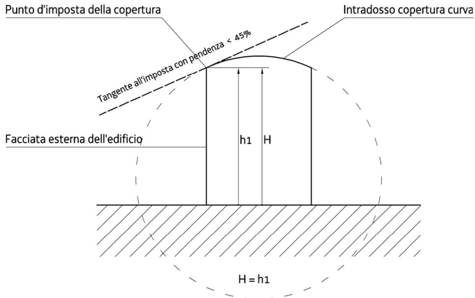
Esempio di misura dell'altezza dell'edificio (H) con copertura curva
